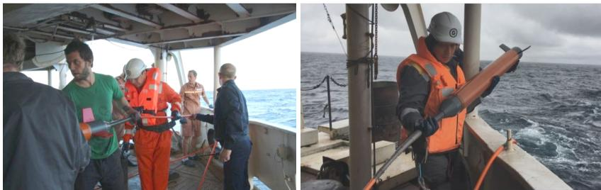
Рис.6. Работа с протонными морскими магнитометрами на борту ОИС «Адмирал Владимирский»
